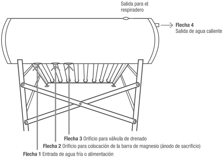
Cerciórese de instalar muy bien la barra en la parte inferior del termo-tanque usando un poco de cinta teflón y sellador de roscas para evitar goteras.
